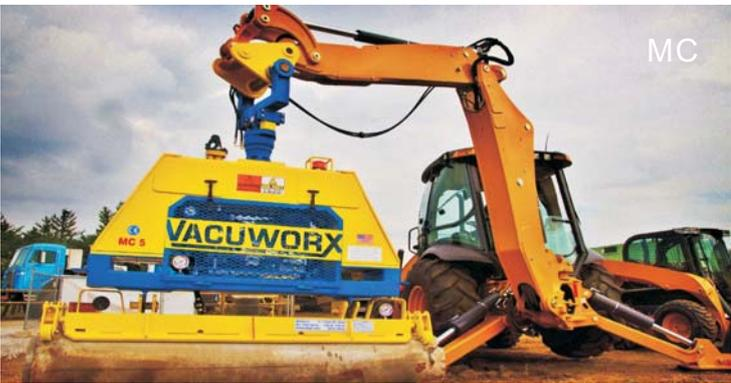
MC系列真空搬運系統為輕量化設計，用於重量輕，規格較小尺寸的應用，尤其適合在公共設施和廠內使用，從3~5噸等不同重量的搬運。
