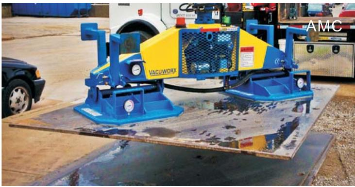
AMC系列是大型物件真空搬運系統，搬運重量可達6噸，是一個物料輸送安全及多功能的真空搬運系統，適用於鋼管，聚乙烯管或混凝土管，平板或混凝土板等，可安裝於大型挖土機等機具上，或大型起重機上，輕巧獨立的設計，採用液壓動力來消除燃料成本、排放和噪音。
