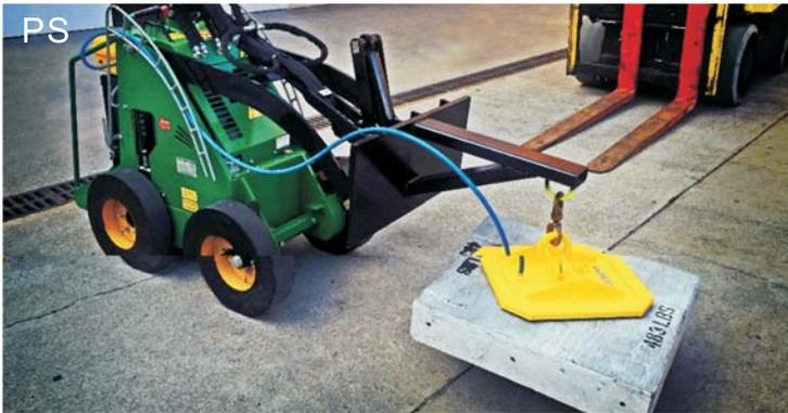
PS系列是一種輕便型的真空搬運系統，主要用於小型物件搬運，可吊掛於起重機或吊車上，進行真空搬運的工作。真空吸重荷重可達0.8噸，可輕便使用於鋼板、鋼材、大理石板等物件搬運。
